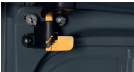
Cette solution intelligente permet à une porte arrière de rester ouverte.
