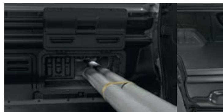
La trappe de la section intermédiaire peut être relevée pour transporter des objets très longs - jusqu'à 3,75 m dans la Primastar L1 ou 4,15 m dans la Primastar L2\*.
